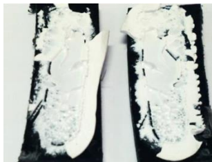
Figura 8: Falha coesiva do adesivo poliuretano. Teste de tração em polipropileno com 20% de carga tratado com plasma.
