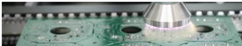
Fig 1: Placa montada sendo tratada com plasma antes do processo de conformal coating.
