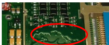
Fig 2: Baixa tensão superficial impede o molhamento completo do conformal coating no PCB.
