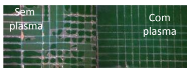
Fig 3: Ativação por plasma melhora a adesão do conformal coating na superfície prolongando a resistência à corrosão
